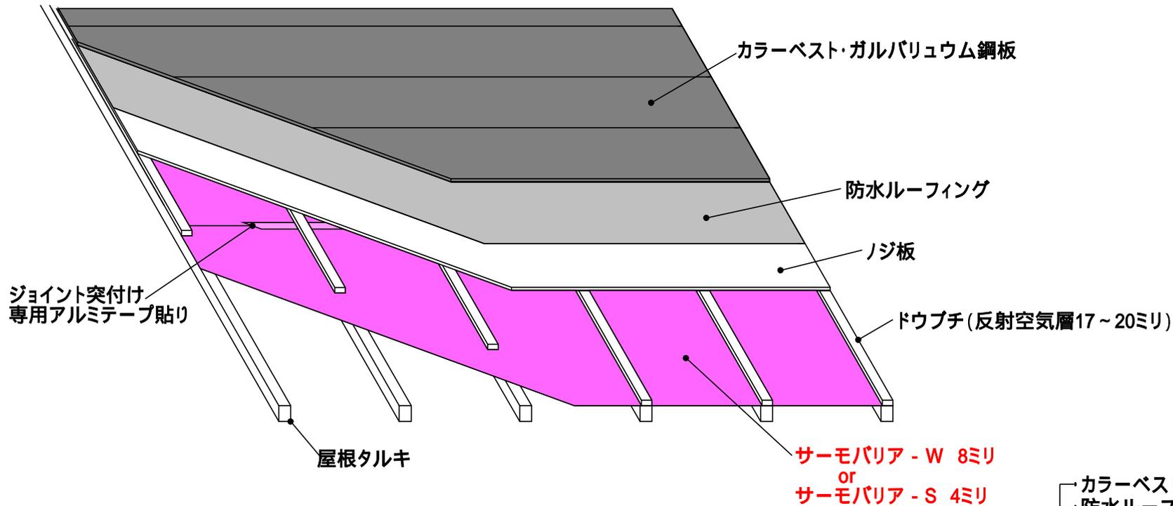
\* サーマバリアのジョイントは突きつけとし、専用アルミテープを貼る
